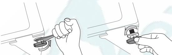
3. Когда стиральная машина будет выровнена, затяните гайки с помощью прилагаемого к стиральной машине гаечного ключа.
