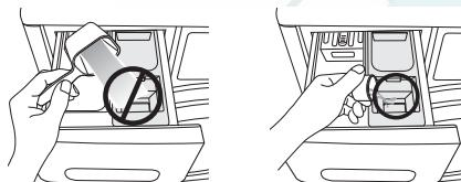
4. При использовании режима предварительной стирки рекомендуемое количество средства для стирки следует добавить в отсек для предварительной стирки ①.
