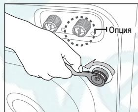
2. Держите болт гаечным ключом и извлеките его через широкую часть отверстия. Повторите процедуру для каждого болта.
